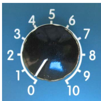
TIG 焊接初期电流和收弧电流设定旋钮
